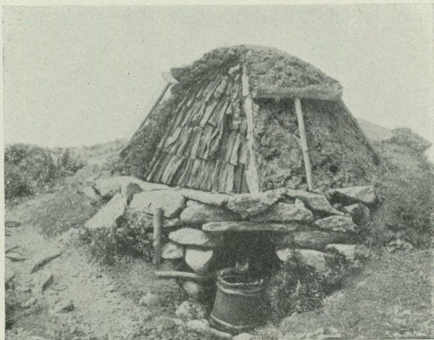
Fig. 6. Modell av tjärmila, efter förebild från Älgå sn, Värmland. (Delvis genomskuren.) Modellen, utförd av A. T. Byberg, tillhör Jubileumsutställningens i Göteborgs Industrihistoriska avdelning.
